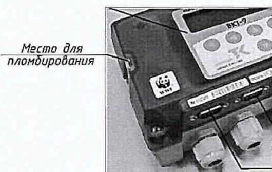
Схема пломбирования тепловычислителя
