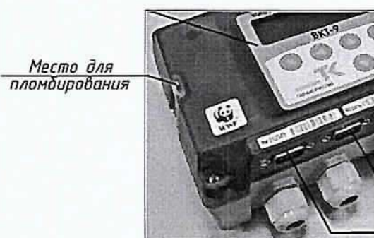
Схема пломбирования тепловычислителя
