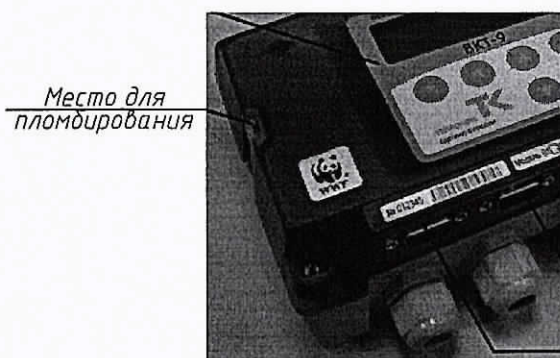
Схема пломбирования тепловычислителя
