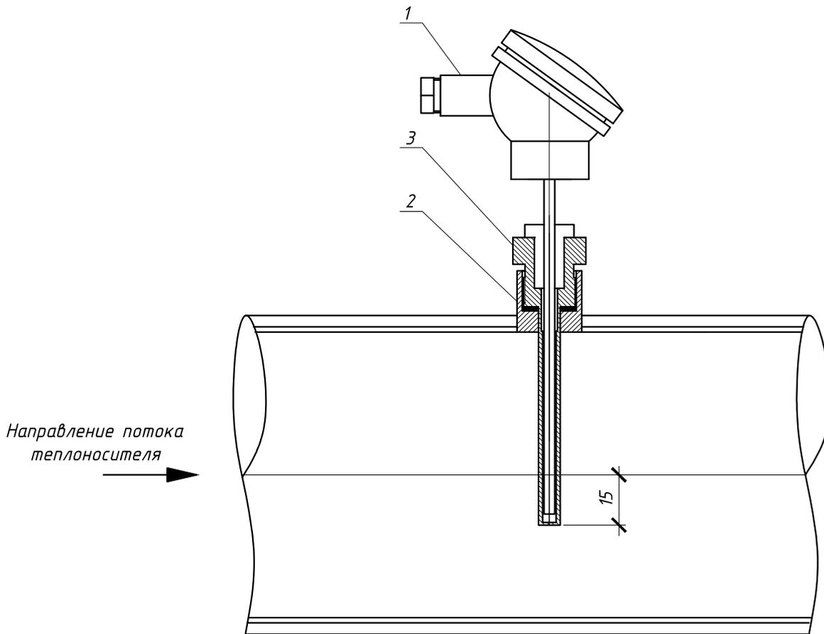
При монтаже термопреобразователь сопротивления опустить за геометрическую ось трубопровода не менее чем на 15 мм
