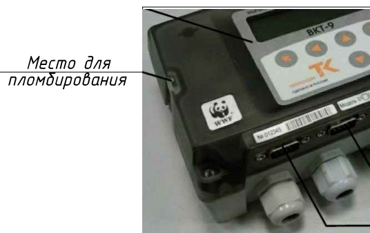
Схема пломбирования тепловычислителя
