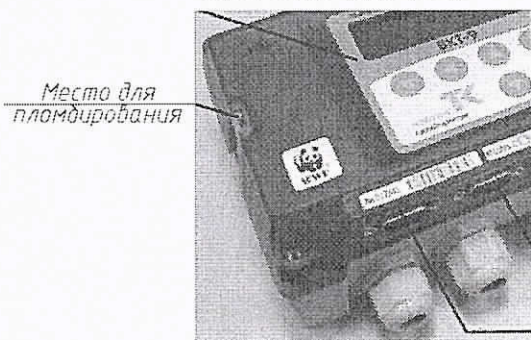
Схема пломбирования тепловычислителя
