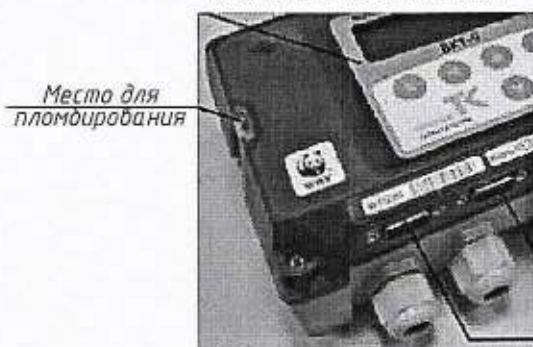
Схема пломбирования тепловычислителя
