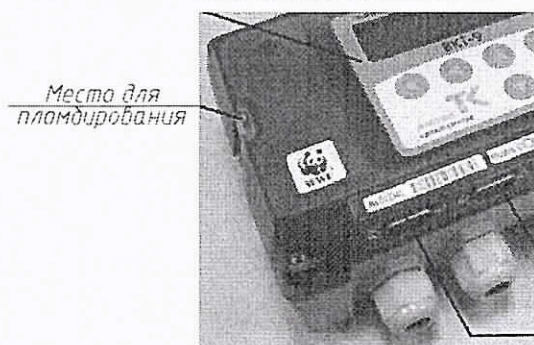
Схема пломбирования тепловычислителя
