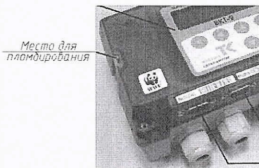
Схема пломбирования тепловычислителя
