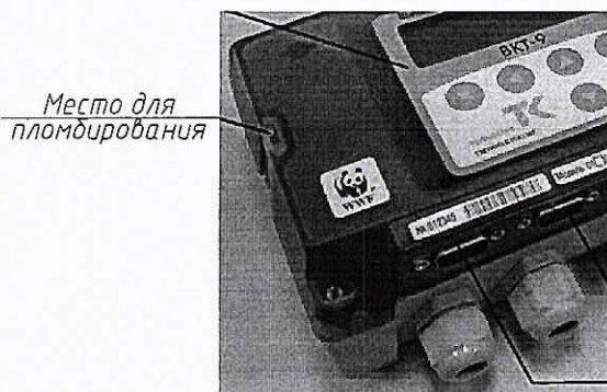
Схема пломбирования тепловычислителя
