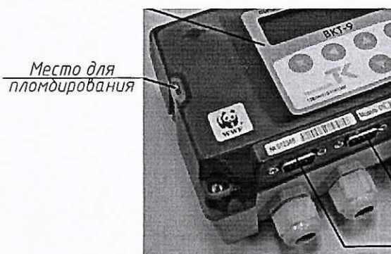
Схема пломбирования тепловычислителя
