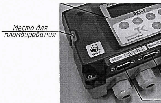
Схема пломбирования тепловычислителя
