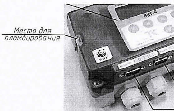
Схема пломбирования тепловычислителя
